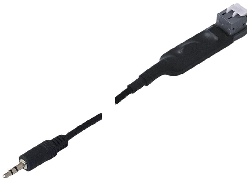
Модуль сопряжения предназначен для подключения обнаружителя БПЛА индивидуального «Алиссум-7» к системам радиоэлектронной борьбы (РЭБ). Модуль сопряжения обеспечивает формирование сигнала управления с выходом типа «сухой контакт», коммутируемое напряжение: не более 200 В, коммутируемый ток не более 100 мА.
